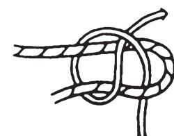
**Škotová spojka** – dříve se používala na lodích k vázání tzv. škotové plachty, odtud dostal uzel svůj název. Jeden z nejpevnějších uzelů, lze s ním vázat i nestejně silná lana (lano – šátek, ...), v tahu se sama ještě více dotahuje.
